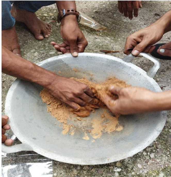
Gambar 4.4 Pencampuran Bahan Perekat dan Serbuk Kulit Asam Hingga Merata
