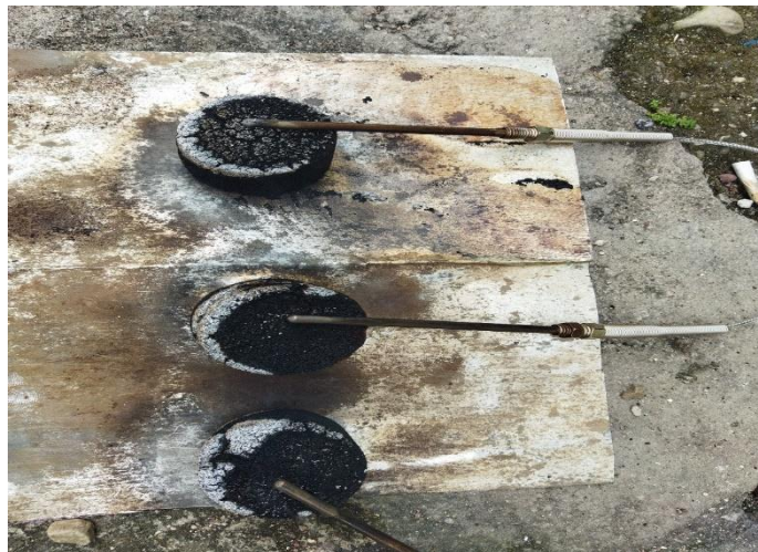
Gambar 4.7. Pengujian lama nyala
