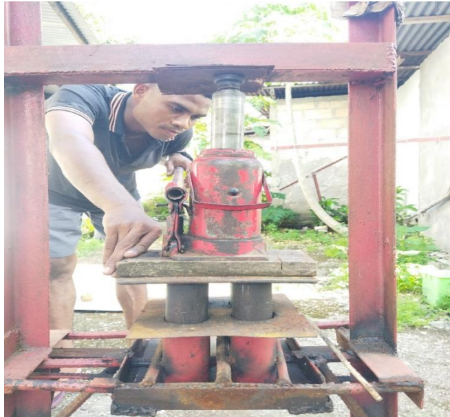
Gambar 4.5 Proses Pencetakan Briket
